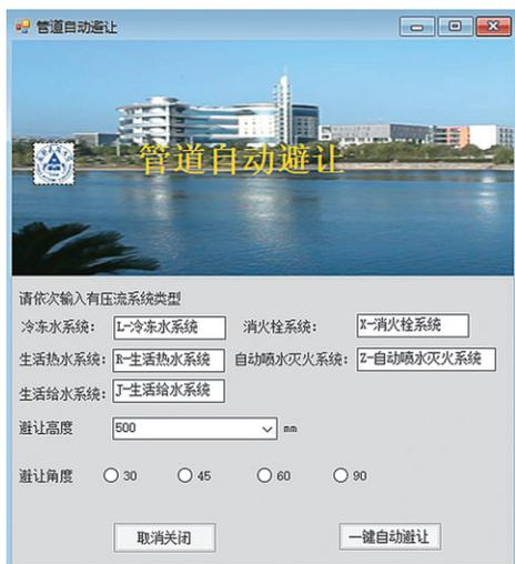
图 3 管线自动避让插件工作界面图
