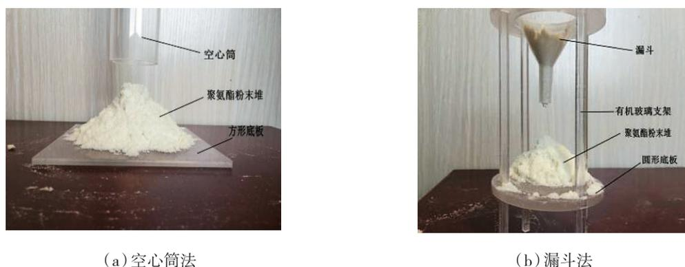
图 1 堆积角测量装置
