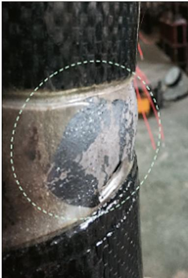
图 3  $G_2$  试件受压侧局部屈曲
