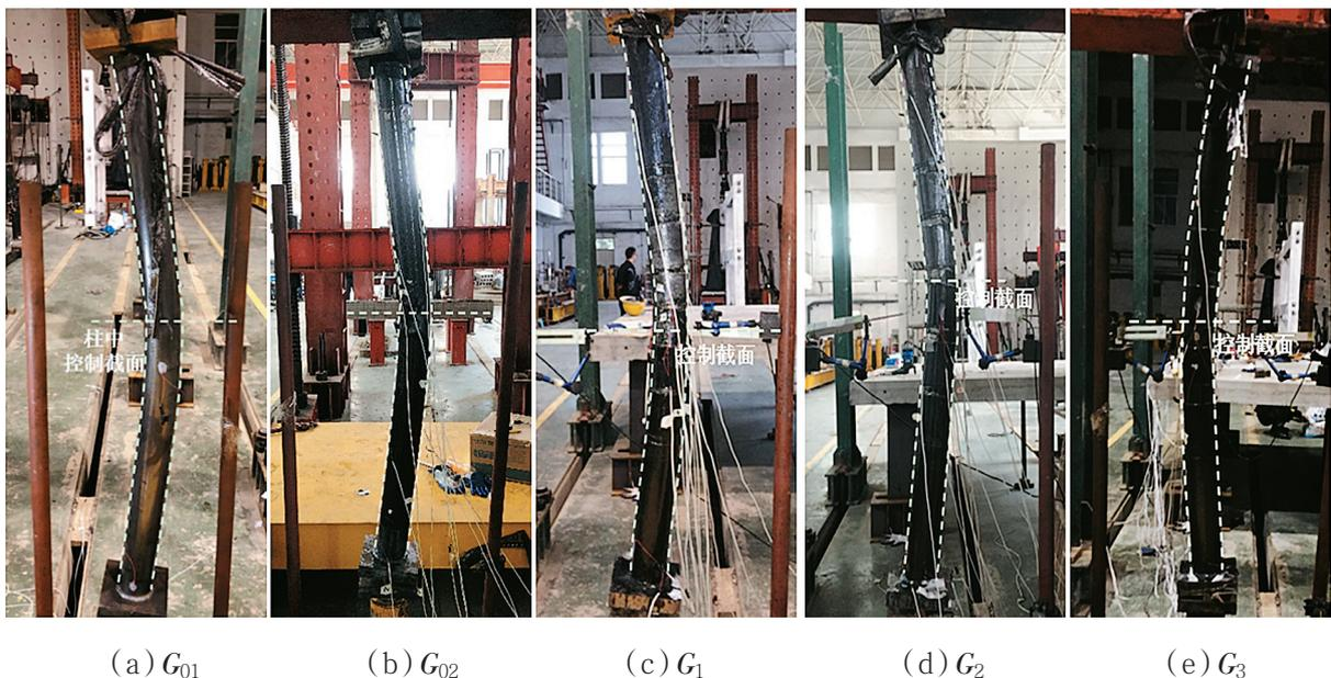
图 2 试验构件的整体破坏模式图
